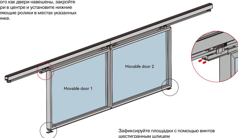
Зафиксируйте площадки с помощью винтов шестигранным шлицем
