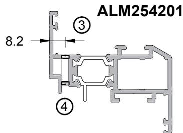
Фрезеровку продольных пазов ③ и ④ 4 x 15 мм выполнять со смещением 50 мм относительно друг друга
