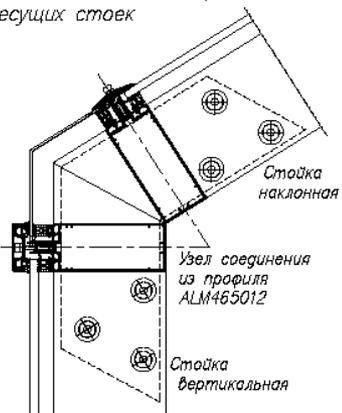
Стык наклонной стойки и горизонтального несущего ригеля
