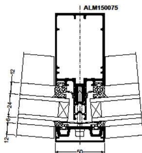
Узел примыкания к стене
