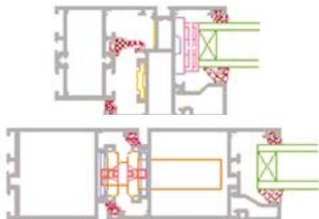
**Серия S 70** – серия алюминиевых профилей с терморазрывом, предназначенная для изготовления витражей, оконных и дверных конструкций.
