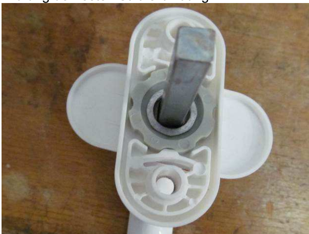
Bild 9 Ansicht des Rastmechanismus
