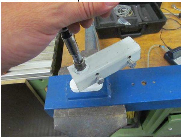
Bild 3 Prüfung des Betätigungs- und Rastdrehmoment
