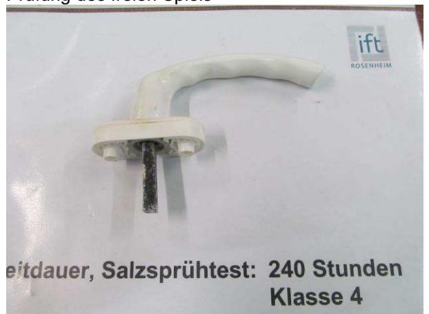
Bild 6 Probekörper nach der Korrosionsprüfung
