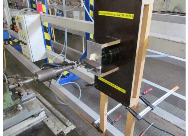
Bild 2 Prüfung der Dauerfunktion
