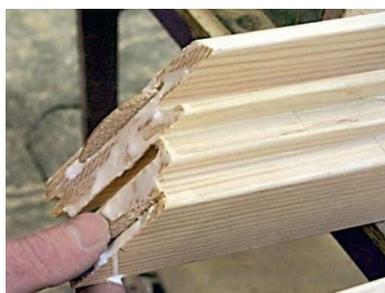
Плоские шканты (ламели) - отличный вариант для столярных соединений и сборки мебели, а также для сборки окон и прочих деревянных конструкций. Ламели произведены из качественной древесины бука, имеют калиброванную толщину и сетчатое тиснение на поверхности для равномерного распределения клея при сборке соединения.
