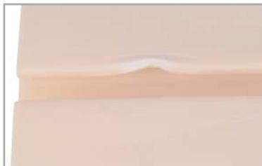
при снятии/установке клипсы цокольной опоры кромка паза ломается
