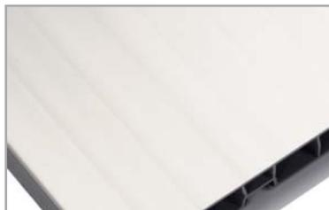
при не соблюдении технологии или при ее отсутствии на декоративной поверхности остаются следы после экструзии
