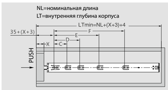
Установочные размеры направляющих
