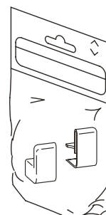
42 + 43 Комплект торцевых заглушек направляющей на створке
