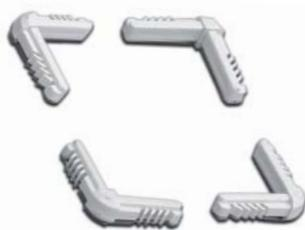
Оптимальное решение проблемы промерзания – применение дистанционной рамки из твердого пластика (коэффициент теплопроводности 0,16-0,17 Вт/(м°С)), что позволяет соблюдать необходимый температурный режим на внутренней поверхности окна и избегать появления конденсата и инея при низких температурах.
