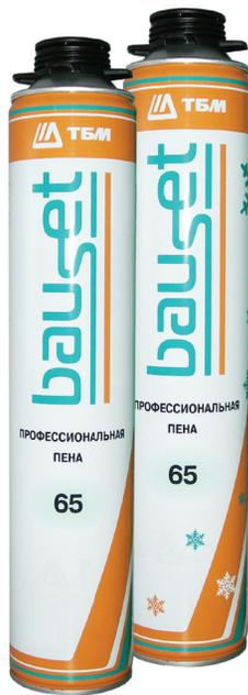
Однокомпонентная профессиональная монтажная пена Bauset 65 (870 мл), застывающая под воздействием влаги воздуха, применяется для герметизации и изоляции в строительстве. Наносится с помощью пистолета. Имеет хорошую адгезию ко всем строительным материалам, за исключением силикона, тефлона и полиэтилена. Выпускается в летнем и зимнем вариантах.
