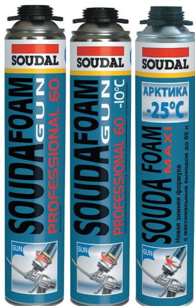
Однокомпонентная профессиональная монтажная пена Soudal, застывающая под воздействием влаги воздуха, применяется для герметизации и изоляции в строительстве. Наносится с помощью пистолета. Имеет отличную адгезию к кирпичу, штукатурке, металлу, цементу, дереву, полистиролу, профилям ПВХ, стеклу, застывшим полиуретанам и т.д. Обладает хорошими звукопоглощающими и термоизоляционными свойствами. Выпускается в летнем и зимнем вариантах.
