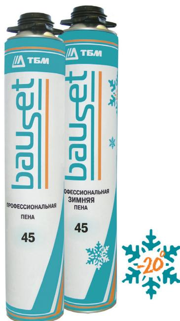
Однокомпонентная профессиональная монтажная пена Bauset 45 (750 мл), застывающая под воздействием влаги воздуха, применяется для герметизации и изоляции в строительстве. Наносится с помощью пистолета. Имеет отличную адгезию к кирпичу, штукатурке, металлу, цементу, дереву, полистиролу, профилям ПВХ, стеклу, застывшим полиуретанам и т.д. Обладает хорошими звукопоглощающими и термоизоляционными свойствами. Выпускается в летнем и зимнем вариантах.
