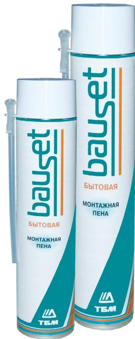
Однокомпонентная бытовая монтажная пена Bauset TR (750 мл и 500 мл), застывающая под воздействием влаги воздуха, применяется при монтаже окон, дверей, заполнении щелей, термо- и звукоизоляции, а также герметизации в строительстве. Имеет отличную адгезию к кирпичу, штукатурке, металлу, цементу, дереву, полистиролу, профилям ПВХ, стеклу, застывшим полиуретанам и т.д.
