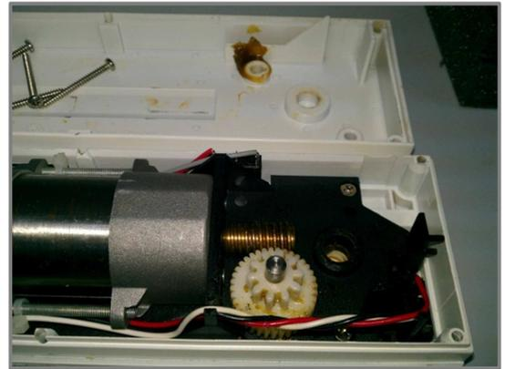
3. Снимите крышку корпуса привода:
