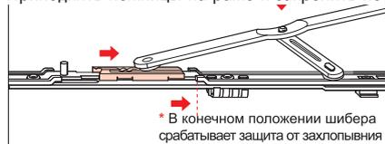
Ножницы 350 и 500 – глубина откидывания, стандарт 140 мм
