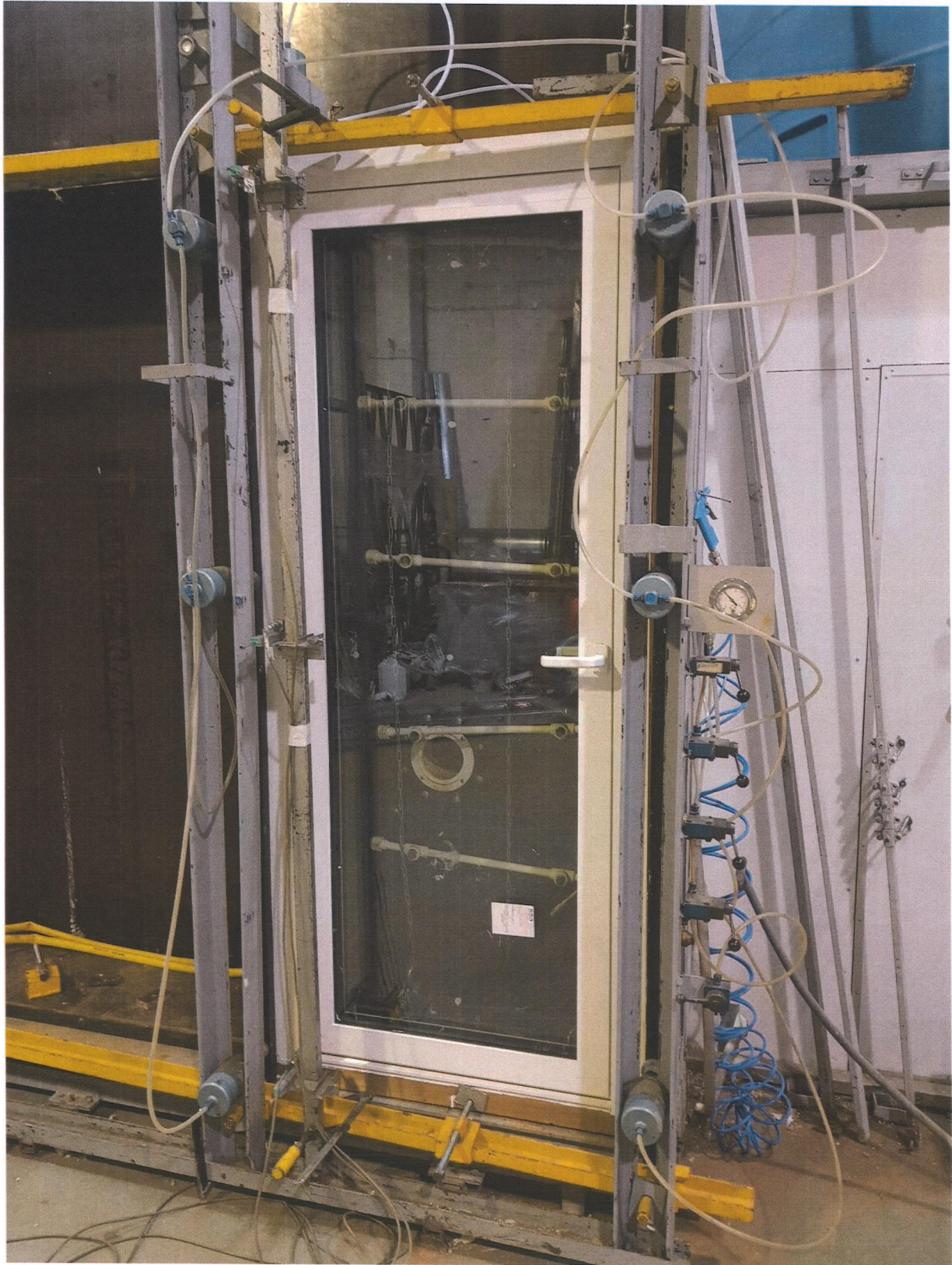
Рис. 8 Внешний вид блока дверного при проведении испытания на сопротивление ветровой нагрузке, точки М4-М6.
