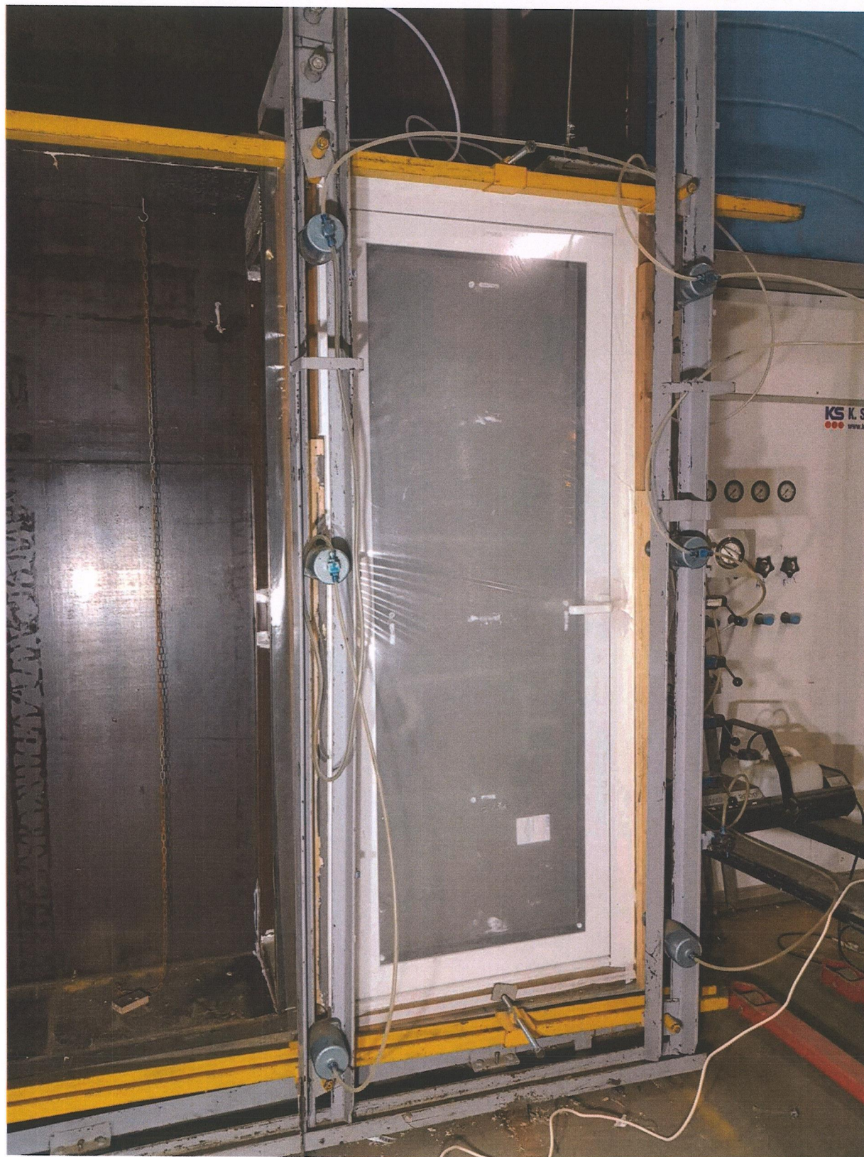
Рис.4 Внешний вид блока дверного при проведении испытания на воздухопроницаемость
