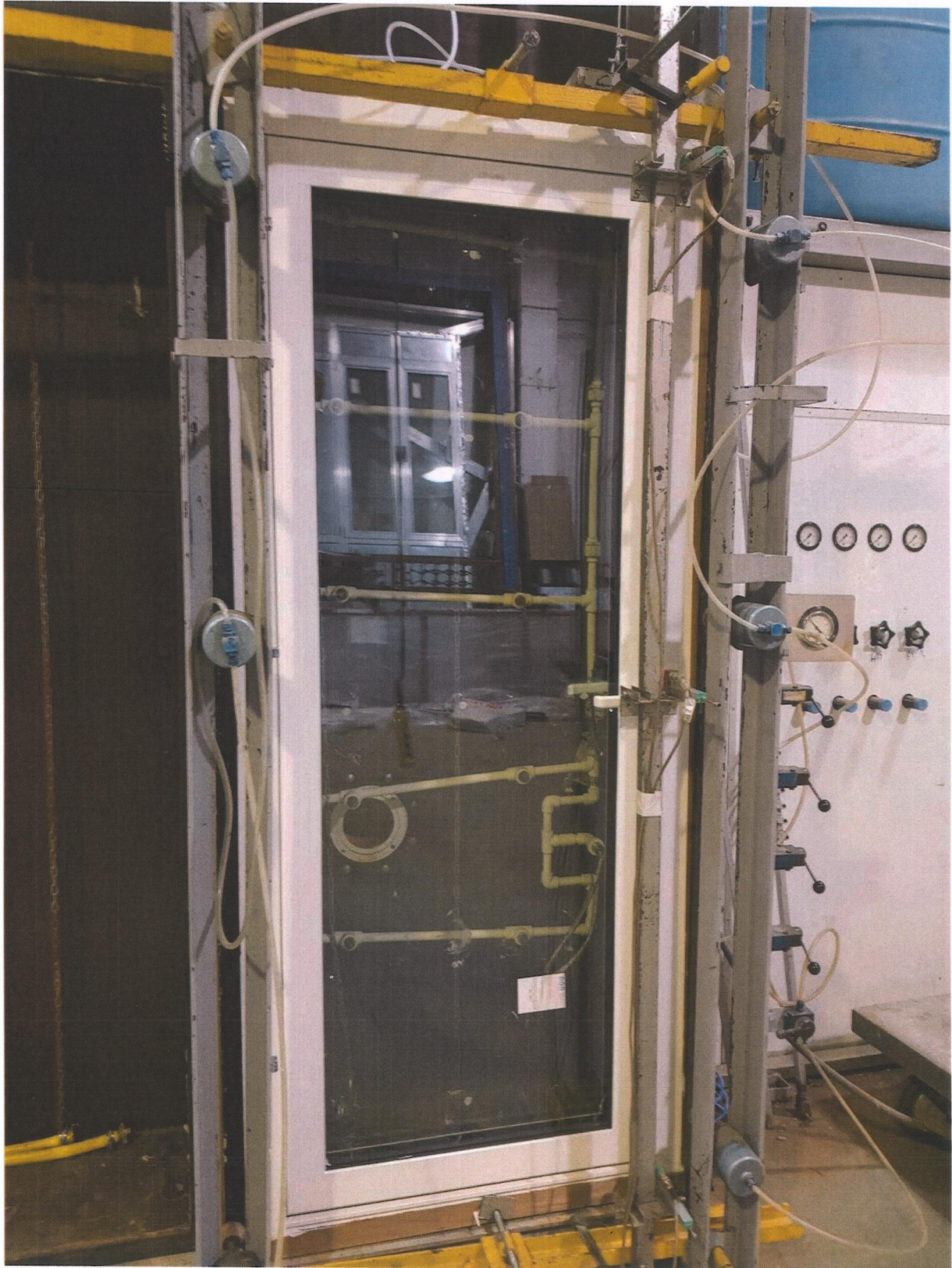
Рис. 6 Внешний вид блока дверного при проведении испытания на сопротивление ветровой нагрузке, точки М1-М3.
