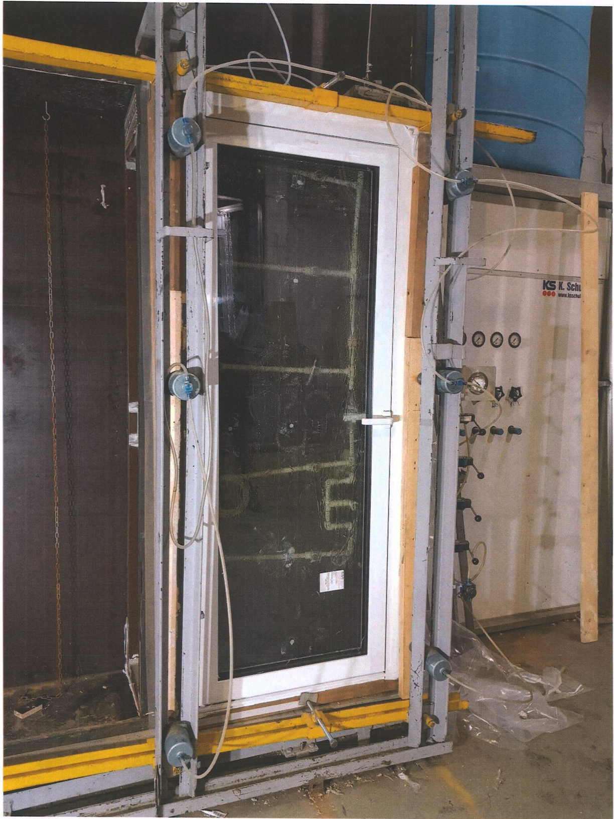
Рис. 5 Внешний вид блока дверного при проведении испытания на водопроницаемость
