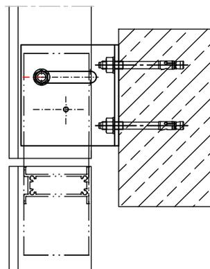
2. Подвижный кронштейн, где стойка может перемещаться в вертикальной плоскости, и имеет свободу при термическом расширении. Применяются кронштейны типа **KNS-M-2.2**.
