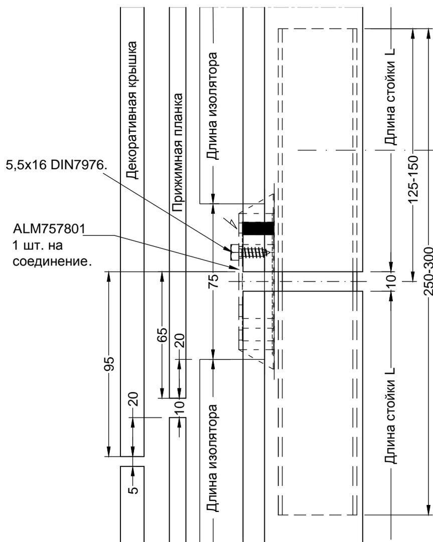
После фиксации детали ALM757801, необходимо верхнее отверстие детали заполнить силиконовым герметиком до момента появления герметика в пазах стойки (20гр).
