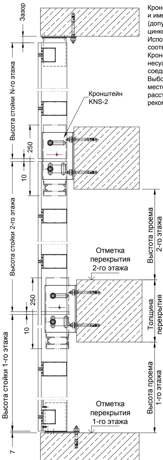
Кронштейны изготавливаются из стали толщиной 5 мм и имеют цинковое покрытие толщиной не менее 9 мкм (допускается полимерное окрашивание либо цинконаполненное покрытие типа "Цинол"). Использовать кронштейны на объекте необходимо в соответствии с проектом и прочностными расчетами. Кронштейны крепятся к несущей конструкции (перекрытие, несущая балка и т.д.) с помощью анкеров или сварного соединения.
