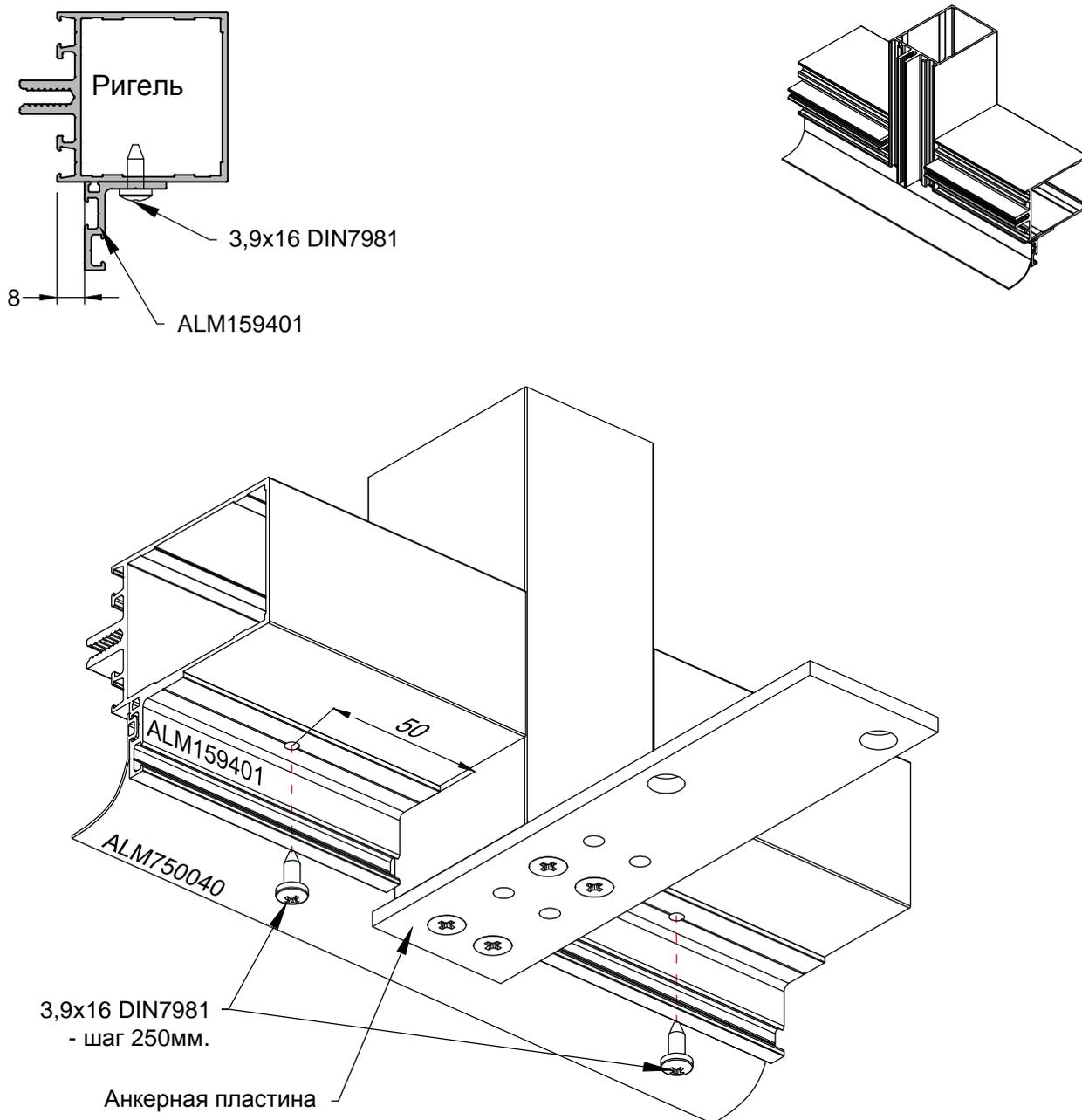
1. Отрезать профиль для гидроизоляции ALM159401 в размер горизонтального ригеля.
