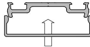
Следует избегать сочетания вертикальных (стойка) и горизонтальных (ригель) декоративных крышек одинаковой монтажной глубины .
