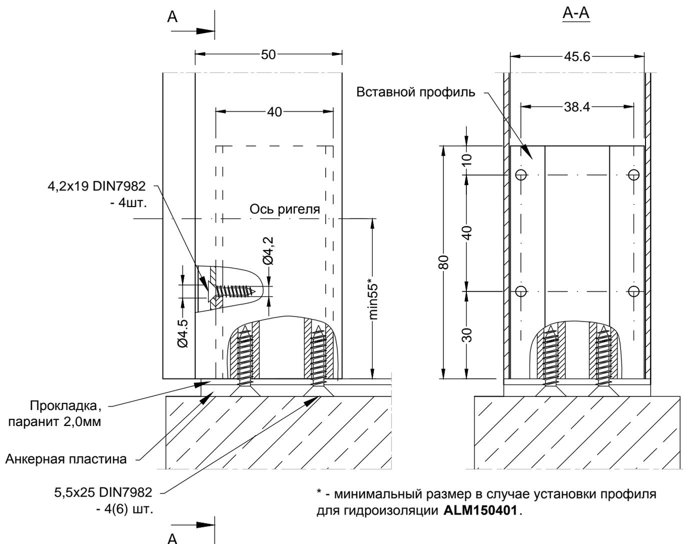
1. Отрезать заготовку вставного профиля в необходимый размер с таким расчетом , чтобы верхняя отметка вставного профиля располагалась выше оси ригеля на 25мм.
