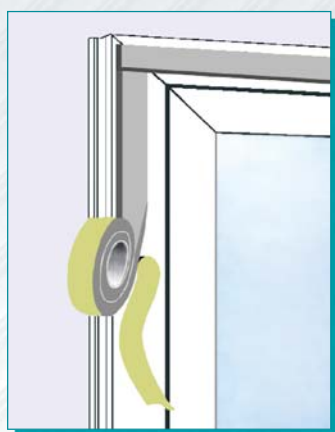
Рис. 6. Схема приклеивания ПСУЛ
