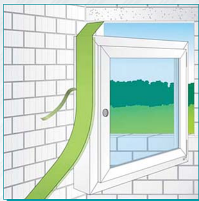
Рис. 8. Установка внутренней пароизоляционной дублированной ленты
