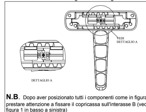
**N.B.** Dopo aver posizionato tutti i componenti come in figura, prestare attenzione a fissare il copricassa sull'interasse B (vedi figura 1 in basso a sinistra)
