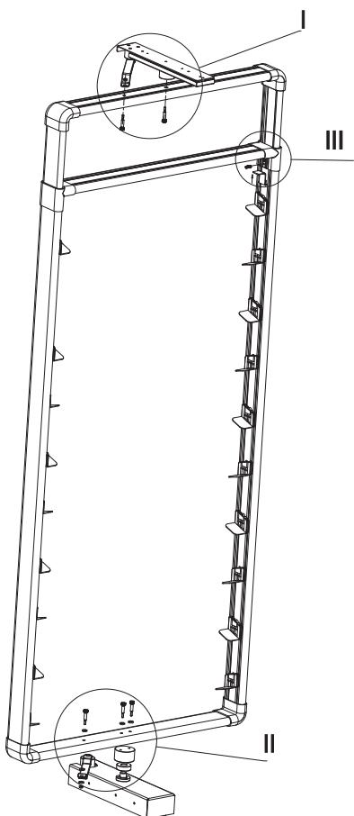
Закрепите раму обувницы к верхней направляющей с помощью винтов M5x20, согласно схеме справа.
