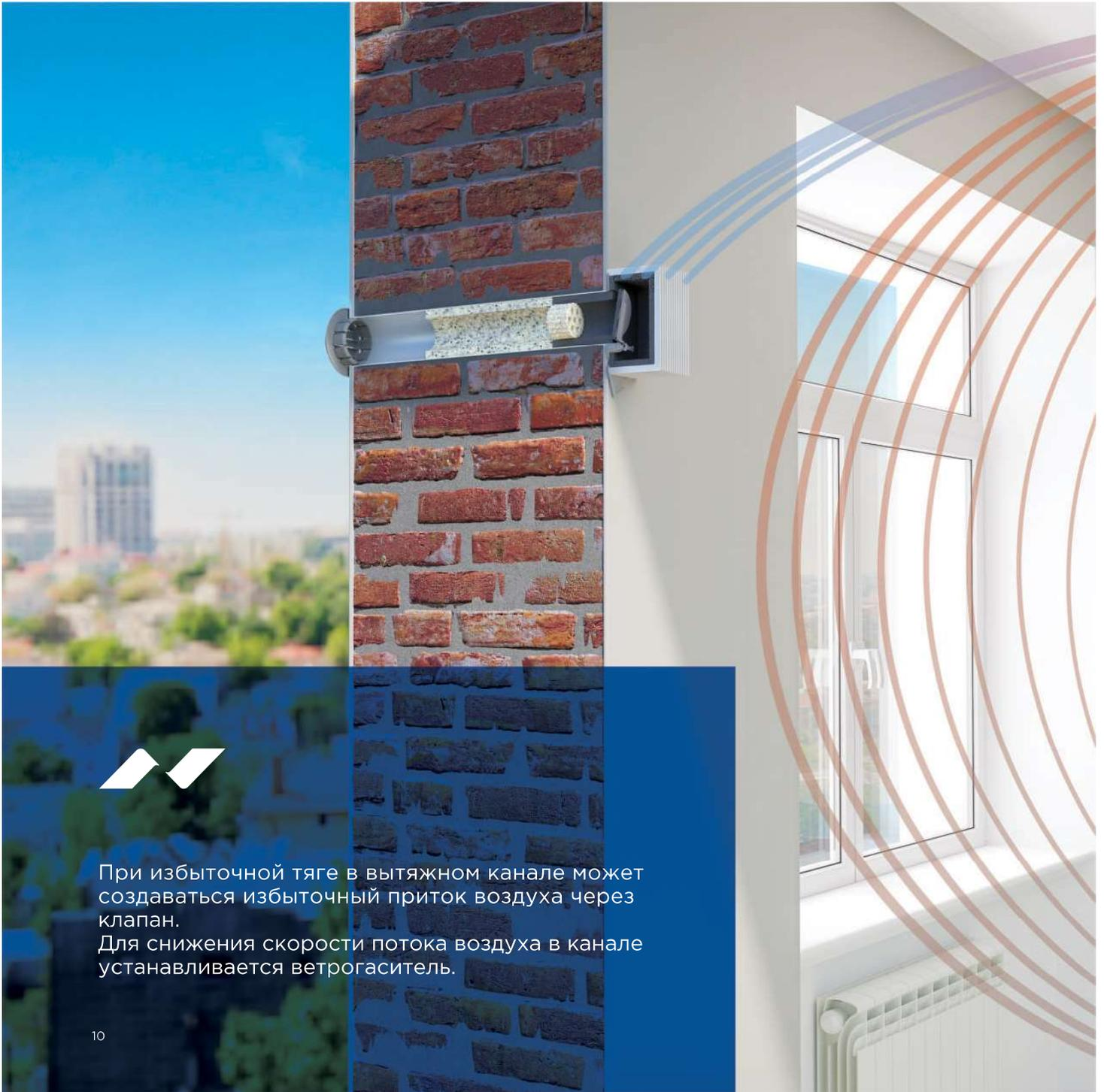
При избыточной тяге в вытяжном канале может создаваться избыточный приток воздуха через клапан.
