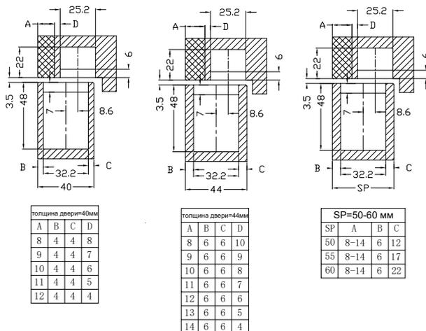
чертеж фрезерования на стороне двери
