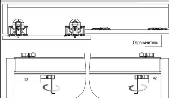
Расположите уповитель двери на расстоянии 42 мм от боковины, закройте дверь и скорректируйте наложение. Зафиксируйте уповитель. После установки ограничителя и полностью открытой внутренней двери установите уповитель с противоположной стороны на расстоянии 92 мм от боковины.
