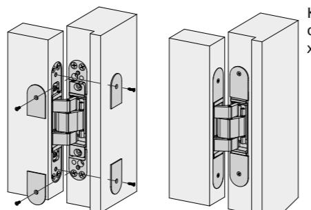
Крепите колпачки с помощью соответствующих винтов, в ходящих в комплект поставки.
