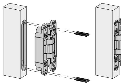
Вставить петлевую часть с надписью "door" (глубина 35,5 мм) в гнездо в полотне, учитывая правильное направление к открыванию, зафиксировать петлю, используя подходящий крепеж.
