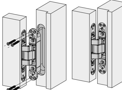
Вставить петлевую часть 29,5 мм в подготовленное посадочное место в дверной коробке, зафиксировав при этом крепежными материалами.
