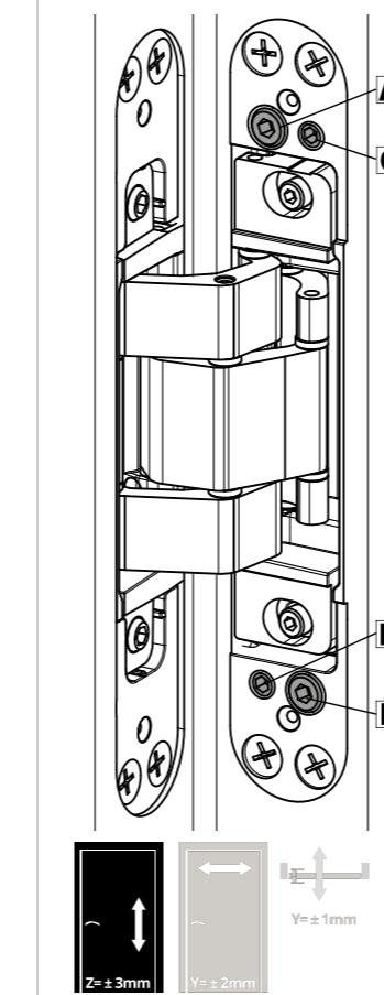
РЕГУЛИРОВКА ПО ГЛУБИНЕ
