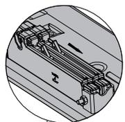
Зафиксируйте верхний ролик на раме для больших корзин с помощью винтов ST4x12
