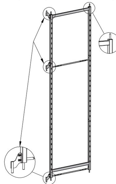
Выверните пластиковые L-образные крепления по краю корпуса. Зафиксируйте с помощью саморезов с потайной головкой ST4x20.
