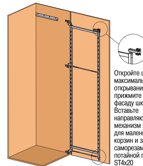
Откройте шкаф на максимальный угол открывания, затем прижмите раму к фасаду шкафа. Вставьте направляющий механизм в раму для маленьких корзин и закрепите саморезами с потайной головкой ST4x20
