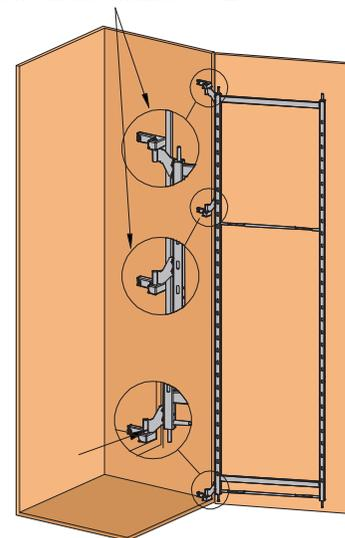
Вставьте раму с предустановленными подвесками в L-образные крепления
