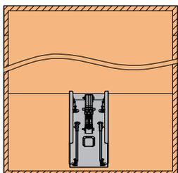
Зафиксируйте нижнюю часть направляющей в соответствии с шаблоном с помощью саморезов ST4 x16
