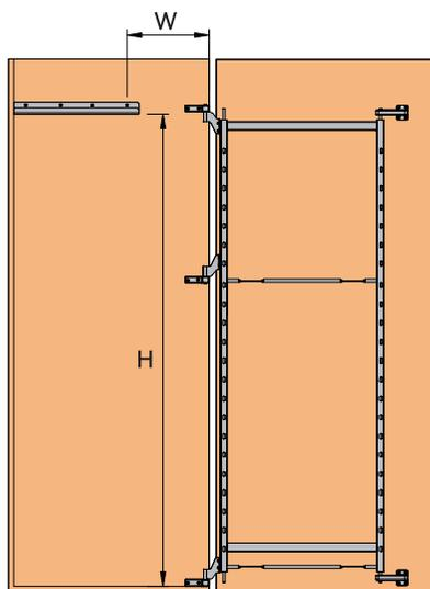
Зафиксируйте верхнюю направляющую на боковине саморезами ST4\*16 в соответствии с размерами, указанными на чертеже
