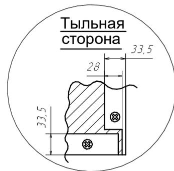
Расчет длины горизонтальной планки (W):
