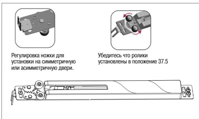
Регулировка ножки для установки на симметричную или асимметричную дверь.
