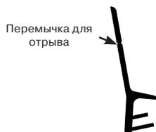
В случае закрепленной винтами приворочной планки на шульповой створке уплотнитель S 6600e полностью закрывает винты.
