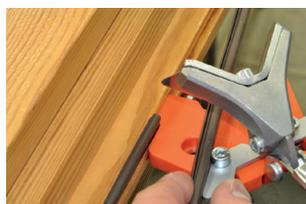
Упор столика приложить к началу контура уплотнителя как показано на рисунке и выполнить конечную резку уплотнителя
