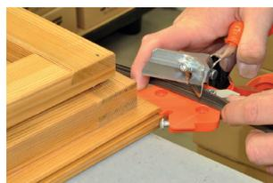
Вставить столик в паз створки, при необходимости отрегулировать расстояние с помощью регулировочного винта и положить уплотнитель на столик и прижать его к стопорной пластине
