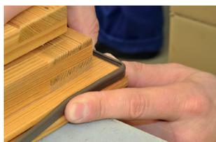
Уплотнитель обернуть вокруг угла и вставить в паз; шаги 2-6 повторить для других углов
