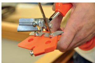
Отрегулируйте стопорную пластину на желаемую ширину уплотнителя
