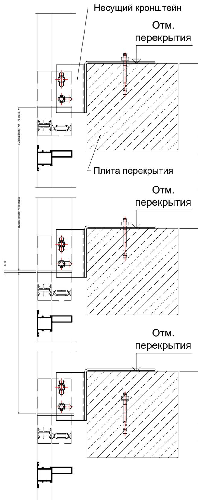
Кронштейны изготавливаются из стали толщиной не менее 4 мм и имеют цинковое покрытие толщиной не менее 20 мкм (допускается полимерное окрашивание либо цинконаполненное покрытие типа "Цинол").
