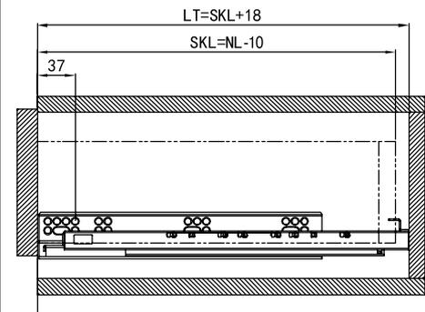
Присадка задней стенки и дна ящика (мм)
