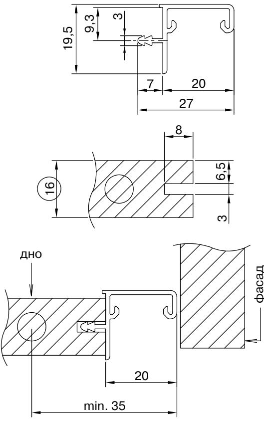
Монтажная схема для ЛДСП 18мм
