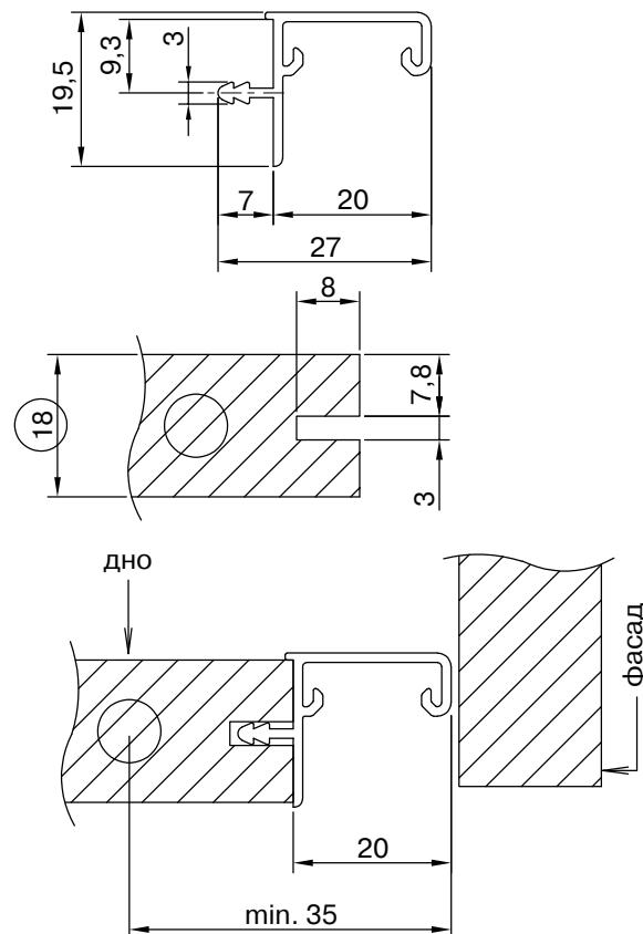
Внимание! Упил дна на 20мм актуален только в случае его затопления относительно боковин. Если детали заподлицо, рекомендуем спиливать минимум 21мм.
