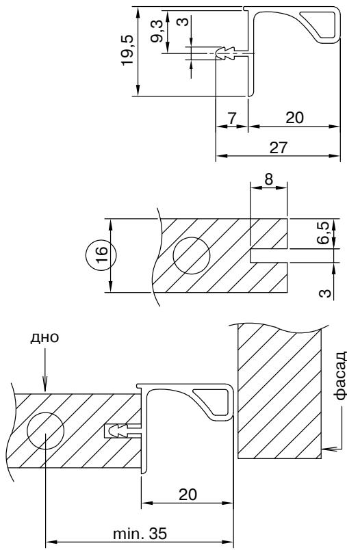
Монтажная схема для ЛДСП 18мм
