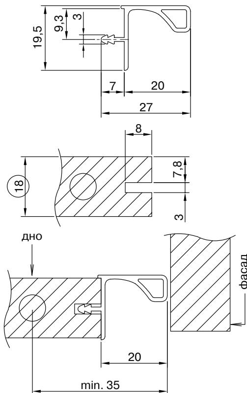
Внимание! Упил дна на 20мм актуален только в случае его затопления относительно боковин. Если детали заподлицо, рекомендуем спиливать минимум 21мм.
