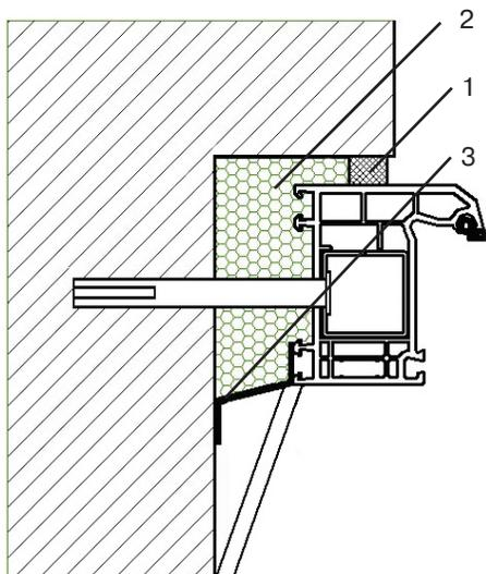
Узел бокового примыкания оконного блока к проему без четверти
