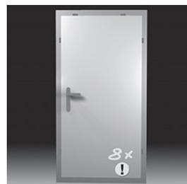
При транспортировке или монтаже дверное полотно должно быть закреплено в раме (например, направляющими, клиньями и т.д.).
