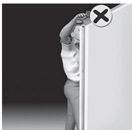
Не допускать попадания мусора (например, при очистке двери от краски) в замок или запорные элементы – они могут попасть в механизм запорной системы и привести к нарушению работы системы.
