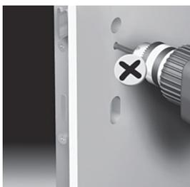
Дверное полотно нельзя просверливать в области замка при установленной многозапорной системе (например, для установки защитной фурнитуры).
