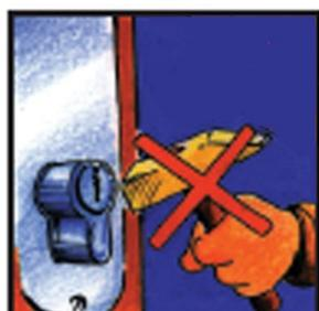
Не применять силу при монтаже цилиндра
