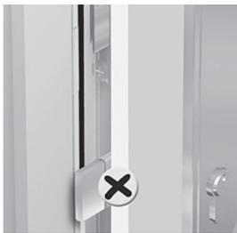
Не приводить запоры в закрытое положение при открытой двери – опасность повреждения о дверную раму при захлопывании.
