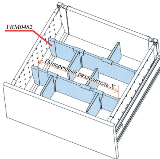
Поперечный разделитель (длина 2 000 мм) нарезается необходимым размером X, согласно следующей формуле:
