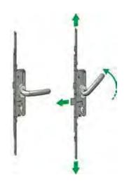
В случае применения замков типа 04645 с многоточечным запиранием, чтобы запереть дверь вам нужно поднять рукоять на 135°, чтобы выдвинуть запирающие элементы.
