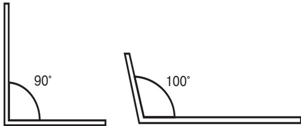
Уголки ПВХ отделочные применяются для монтажа откосов в качестве конечного профиля для декоративного закрытия различных монтажных швов под подоконником и для монтажа наружных откосов.
