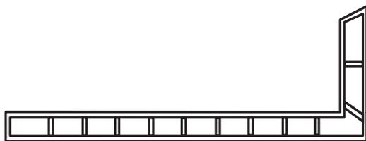
Уголки ПВХ полые применяются для декоративного закрытия монтажных швов под подоконником и для монтажа наружных откосов.
